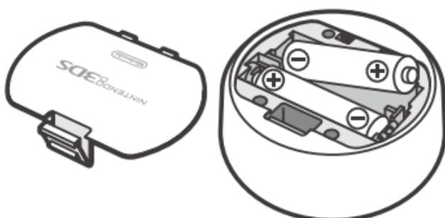
電池が正しくセットされていることを確認し、電池カバーの2つのツメの部分をしっかり引っかけて、電池カバーをカチッと音がするまで取り付けてください。
