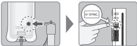
Wiiリモコンプラスのプレイヤーインジケータが点滅(※)したあと、4つのうちのいずれかが点灯すると、登録は完了です。くわしくは、Wii本体取扱説明書 準備編「Wiiリモコンプラスの登録方法」をご覧ください。
